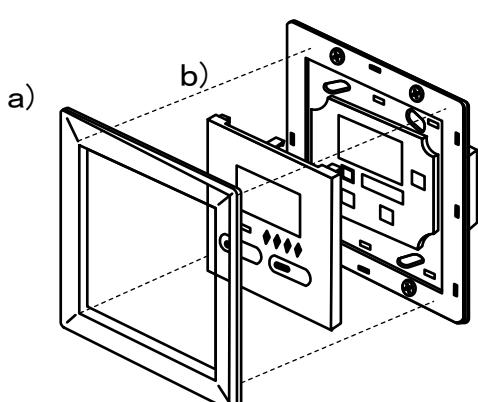
②設置前にa)のプレート枠をはずした後、b)のパネルをはずします。
