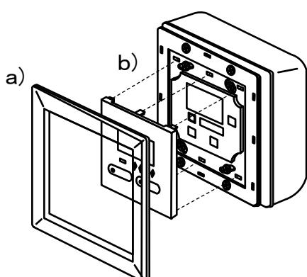
⑤b)のパネルをコントローラーのツメに合わせて取付けた後、a)のプレート枠を取付けます。
