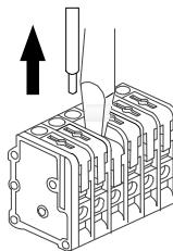
②上記①のボタンを押し下げたままの状態で電源挿入口から電線を引き抜きます。
