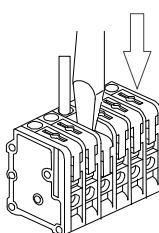
①ドライバーなどの工具を使ってリリースボタンを押し下げます。
