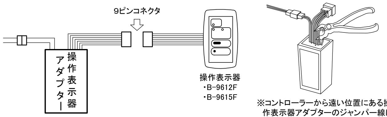
株式会社ゴールおよび堀商店の電気錠を使用する場合は電気錠アダプターの配線を以下の接続表のとおりに接続してください(表内の「-」は使用しない線です)。接続箇所はハンダ付けのうえ、絶縁処理をしてください。
