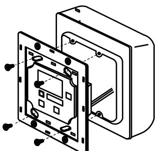
④コードなどをはさまないように取付けビス4本(M4 × 30mm推奨)で、埋込ボックスにコントローラーを取付けます。
